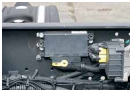
Блок управления системой нейтрализации выхлопных газов (SCR) расположен внутри правого лонжерона рамы и сверху защищен его полкой. Выход из строя блока – событие достаточно редкое
